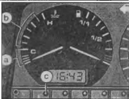
Рис. 1.13 Индикация температуры охлаждающей жидкости а - зона низкой температуры, в - зона рабочей температуры, с - контрольная лампа
