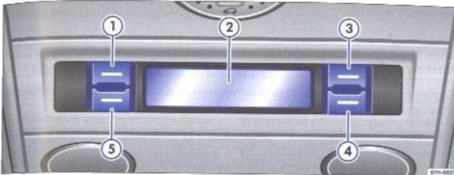
Rys. 73 Fragment tapicerki dachu: elementy obsługi ogrzewania postojowego.
