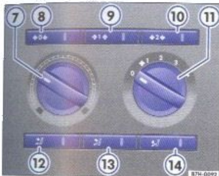
Rys. 65 Układ klimatyzacji: widok elementów obsługi z tyłu, w tapicerce dachu.
