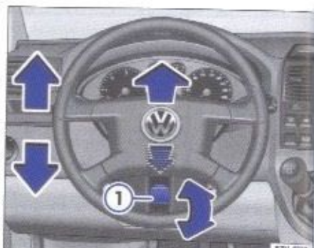
Rys. 45 Dźwignia ręcznego ustawiania kierownicy.
