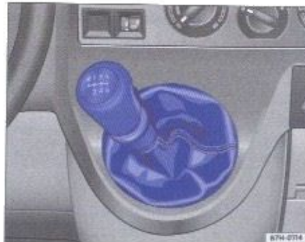
Rys. 82. Dźwignia przełączania ze schematem dla 6-biegowej skrzyni biegów.
