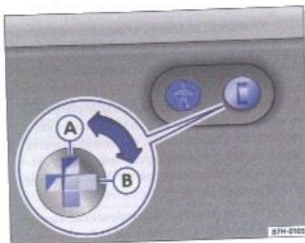
Rys. 18 Blokady otwarcia od wewnątrz w przedniej części pokrywy tylnej.
