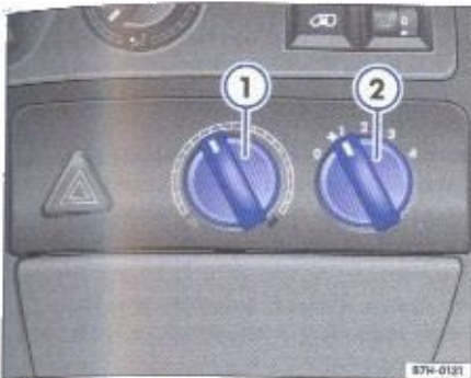
Rys. 71 Dodatkowy wymiennik ciepła: zestawienie elementów obsługi w tablicy przyrządów.
