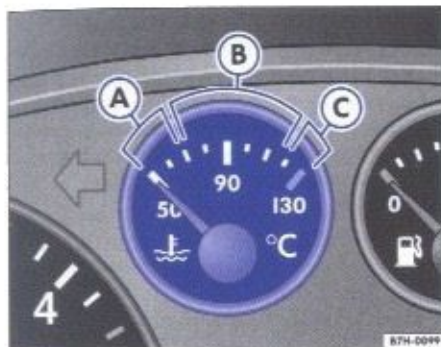
Rys. 4 Fragment zestawu wskaźników: wskaźnik temperatury płynu chłodzącego w silniku
