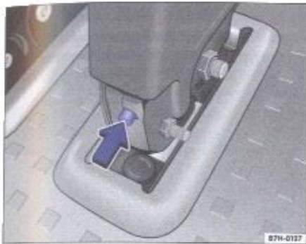
Rys. 58 Fragment uchwyty siedzenia: zabezpieczenie blokadą
