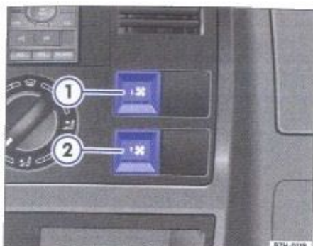
Rys. 33 Fragment tablicy przyrządów: elementy obsługi wentylatora w dachu
