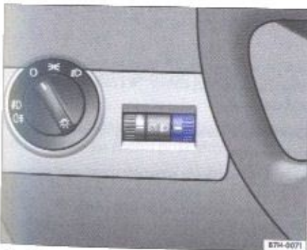
Rys. 29 Fragment tablicy przyrządów: regulacja zasięgu światel
