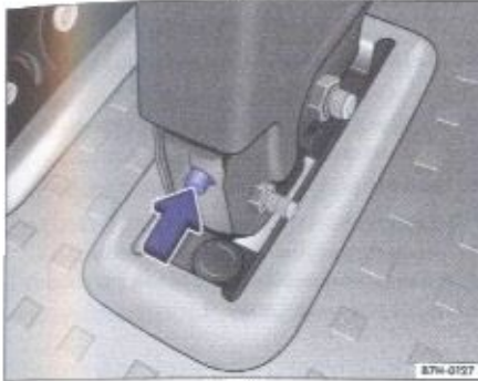
Rys. 53 Fragment uchwyty siedzenia; zabezpieczenie blokadą
