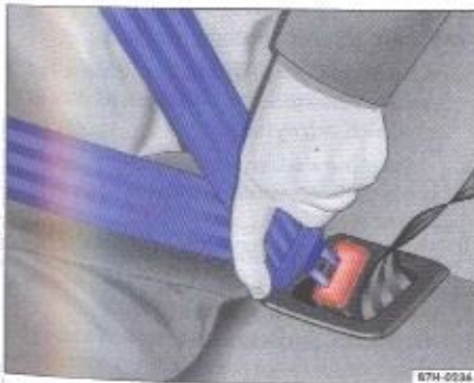
Rys. 54 Zamek i zaczep zamka pasa biodrowego
