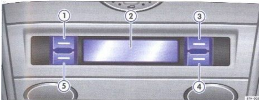
Rys. 76 Fragment tapicerki dachu: elementy obsługi dodatkowego ogrzewania wodnego.
