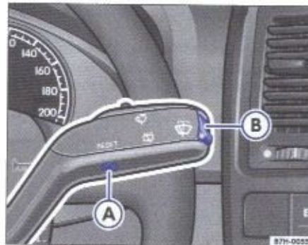
Rys. 7 Dźwignia wycieraczek: przycisk (A) i przełącznik (B)
