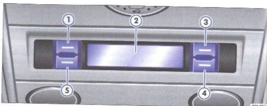
Rys. 74 Fragment tapicerki dachu: elementy obsługi ogrzewania postojowego.
