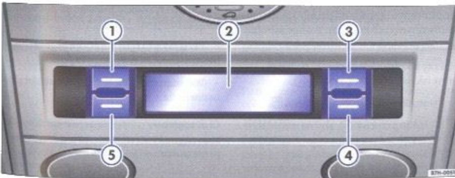
Rys. 72 Fragment tapicerki dachu: elementy obsługi ogrzewania postojowego.
