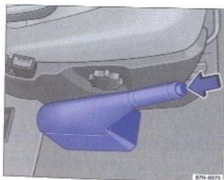
Rys. 83 Wewnątrz przy siedzeniu kierowcy: dźwignia ręcznego hamulca.
