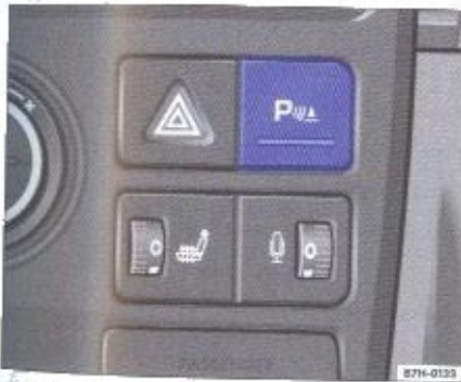
Rys. 86 Fragment tablicy przyrządów: przycisk włączania lub wyłączenia kontroli odstępu podczas parkowania
