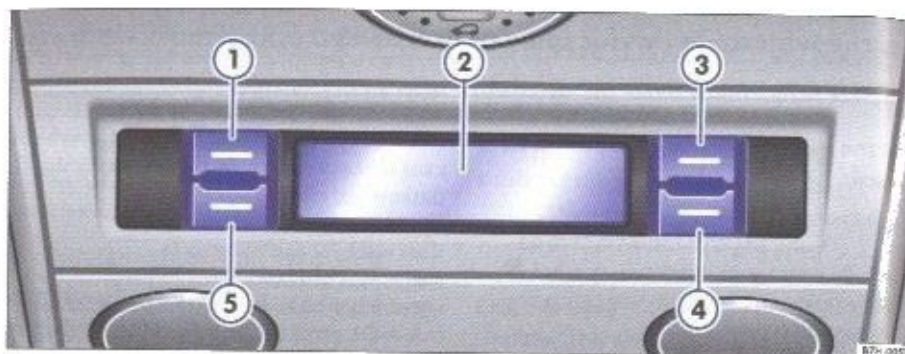
Rys. 78 Fragment tapicerki dochu: elementy obsługi dodatkowego ogrzewania wodnego.
