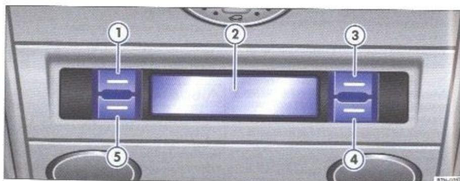
Rys. 77 Fragment tapicerki dachu: elementy obsługi dodatkowego ogrzewania wodnego.
