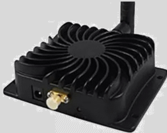
SG-Labs 13cm PA LZ5HP Pout=20W @28V, Gp=16dB 126 €
