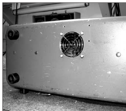
PHOTO 17: Fan vent cutout.
