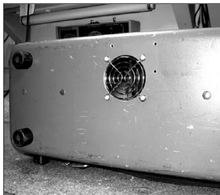
PHOTO 17: Fan vent cutout.
